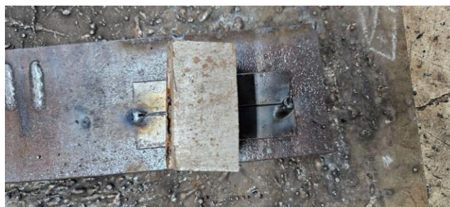
Figura 2. Chapas de aço 1020 antes do processo de soldagem após o ponteamento em ambas as extremidades. Fonte: Autor
